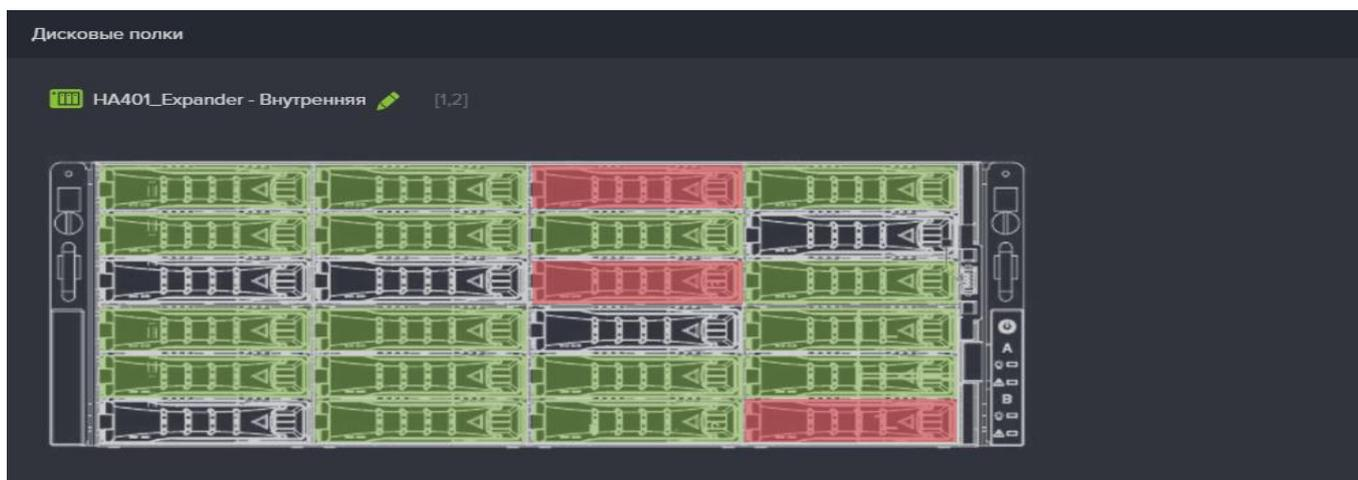
**Рисунок 50. Отображение удаленных или неисправных дисков в меню аппаратного мониторинга**
