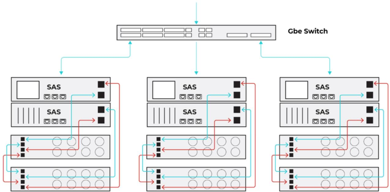
**Рисунок 233. Соединение СХД для работы в многоконтроллерном режиме**
