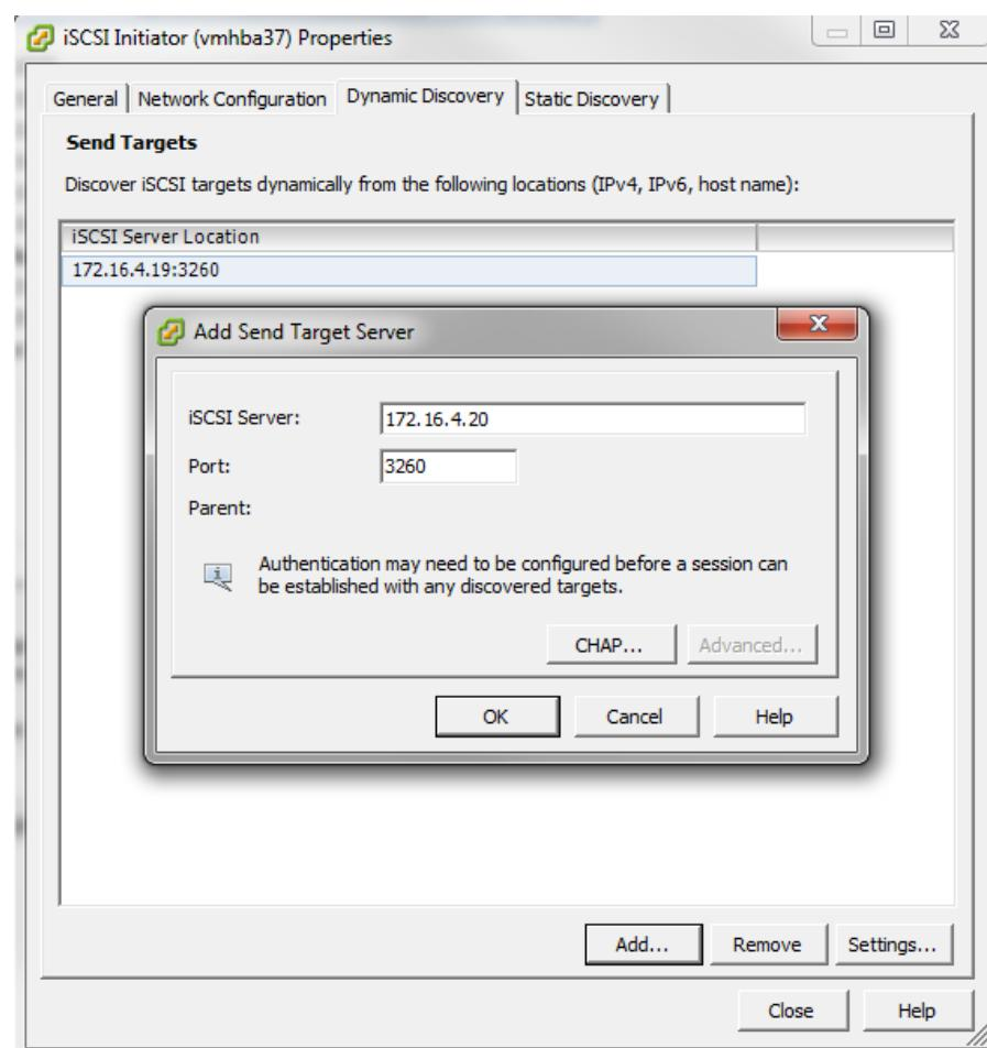
**Рисунок 190. Подключение к iSCSI Targets в VMware ESXi**
