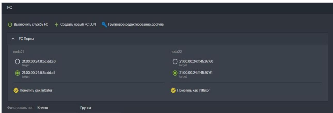
**Рисунок 159. Панель «FC-порты» на вкладке меню «Протоколы» → «FC»**
