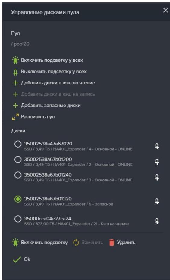
**Рисунок 61. Удаление из пула запасного диска**
