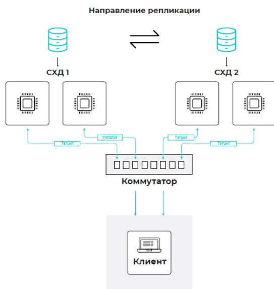
**Рисунок 158. Схема коммутации портов СХД для настройки синхронной репликации**
