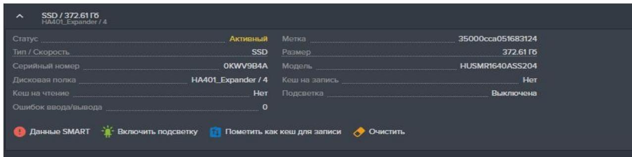
Рисунок 70. Панель свойств диска
