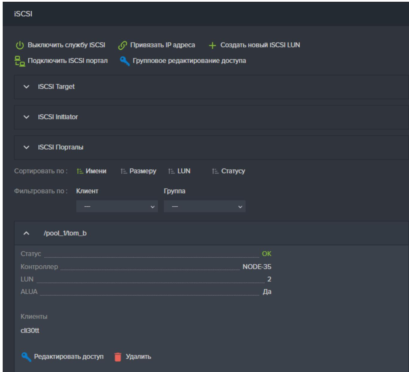
**Рисунок 92. Панель свойств iSCSI LUN**
