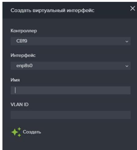
**Рисунок 39. Окно создания виртуального интерфейса**
