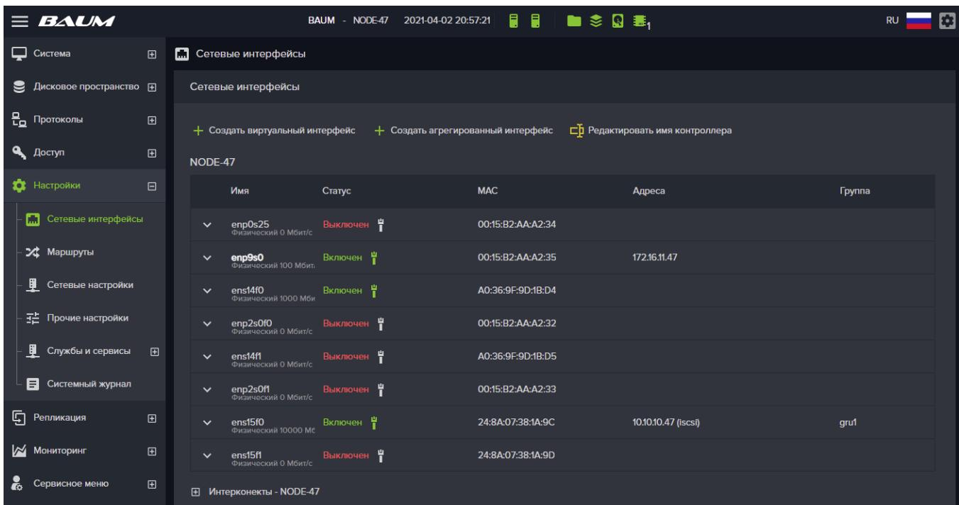
**Рисунок 29. Вкладка меню «Сетевые интерфейсы»**
