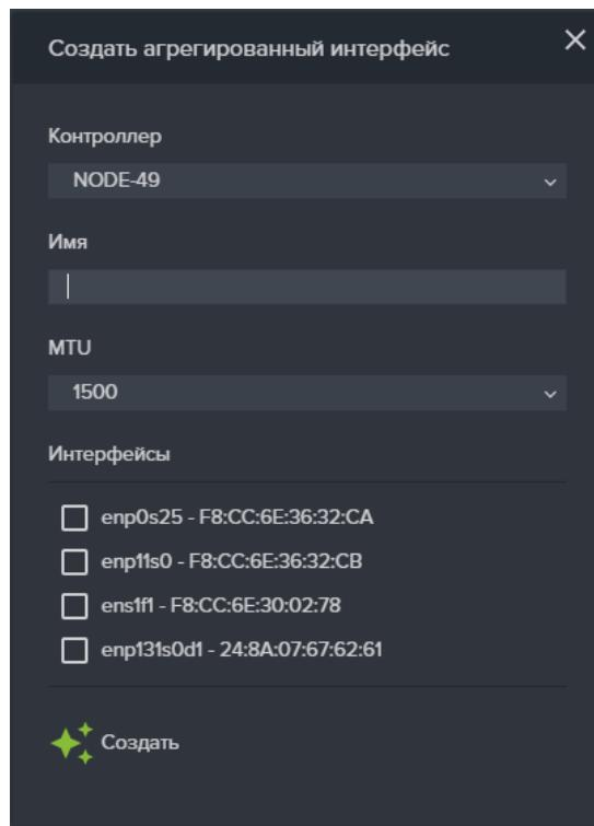
**Рисунок 38. Создание агрегированного интерфейса**
