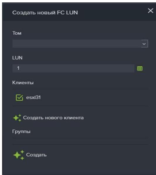
**Рисунок 83. Создание LUN Fibre Channel**
