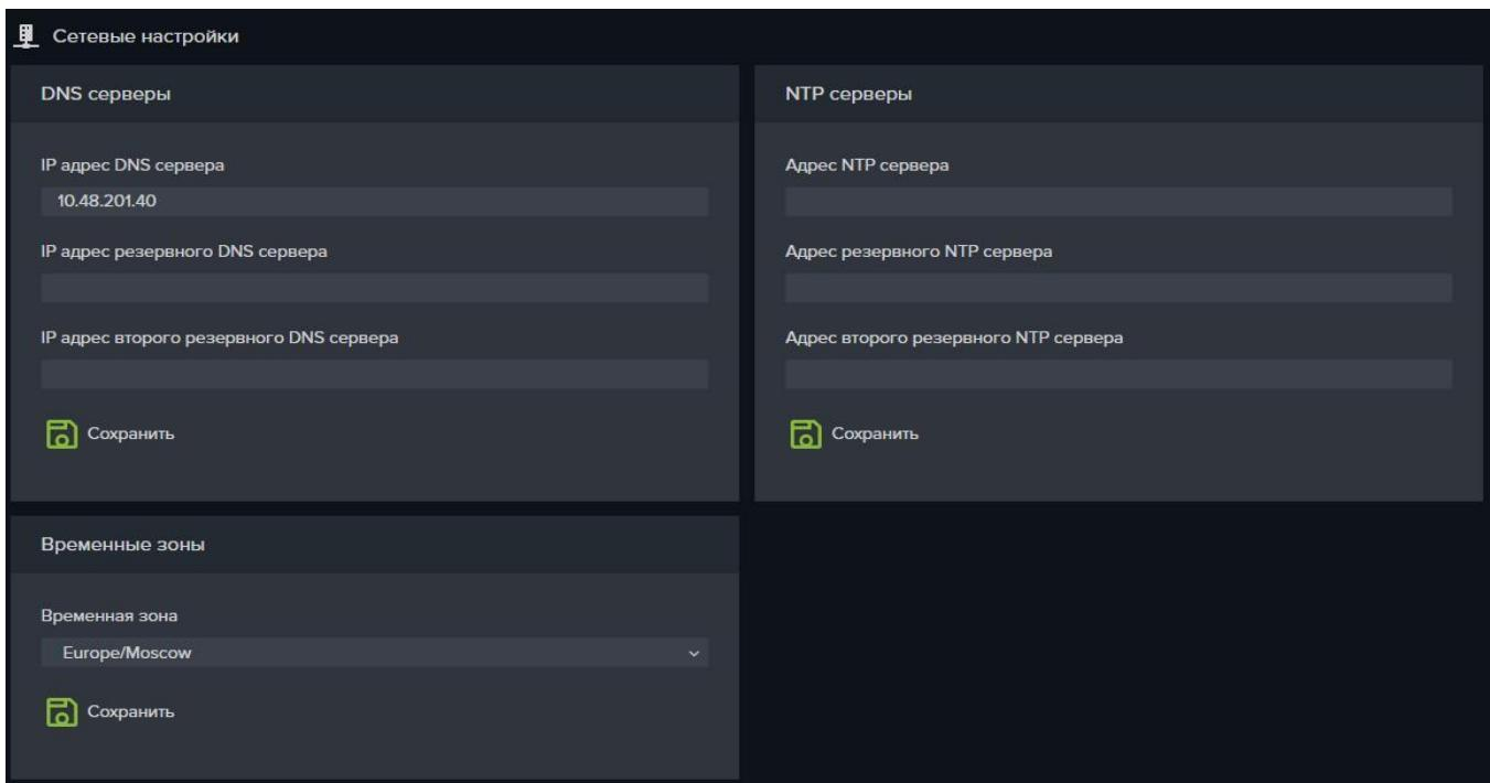
**Рисунок 42. Настройки DNS- и NTP-серверов**
