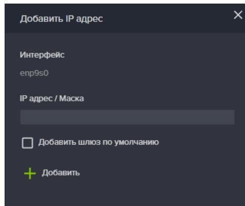
**Рисунок 20. Окно добавления IP-адреса интерфейса**
