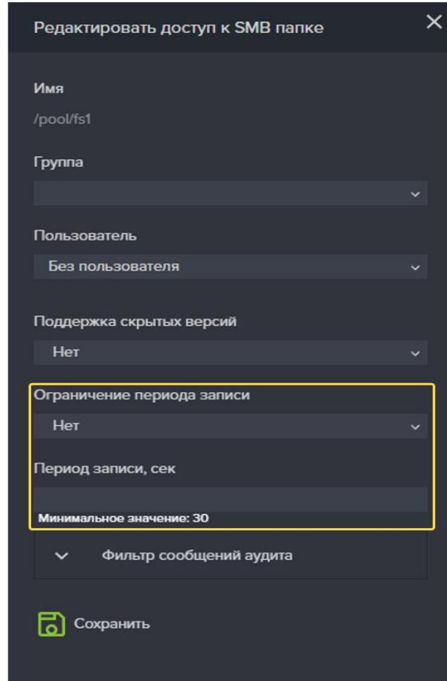
**Рисунок 115. Установка блокировки изменений записанных файлов**
