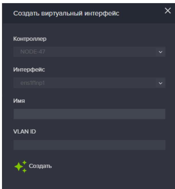
**Рисунок 15. Окно создания виртуального интерфейса**
