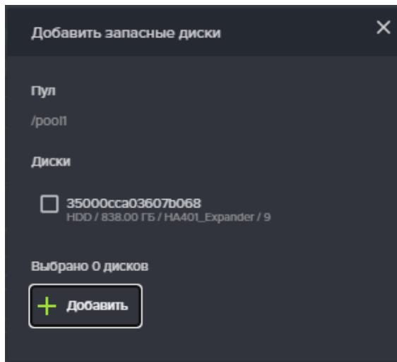
**Рисунок 59. Добавление в пул запасного диска**
