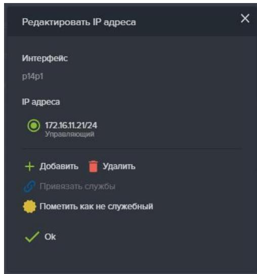
**Рисунок 37. Удаление IP-адреса**
