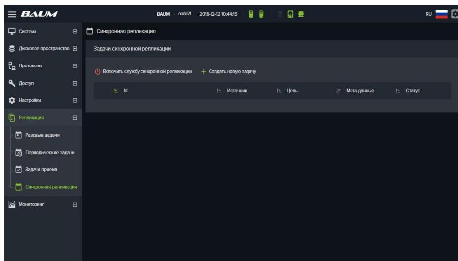
Рисунок 154. Окно меню синхронной репликации
