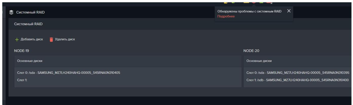
**Рисунок 234. Окно «Системный RAID» показывающее только исправный диск**
