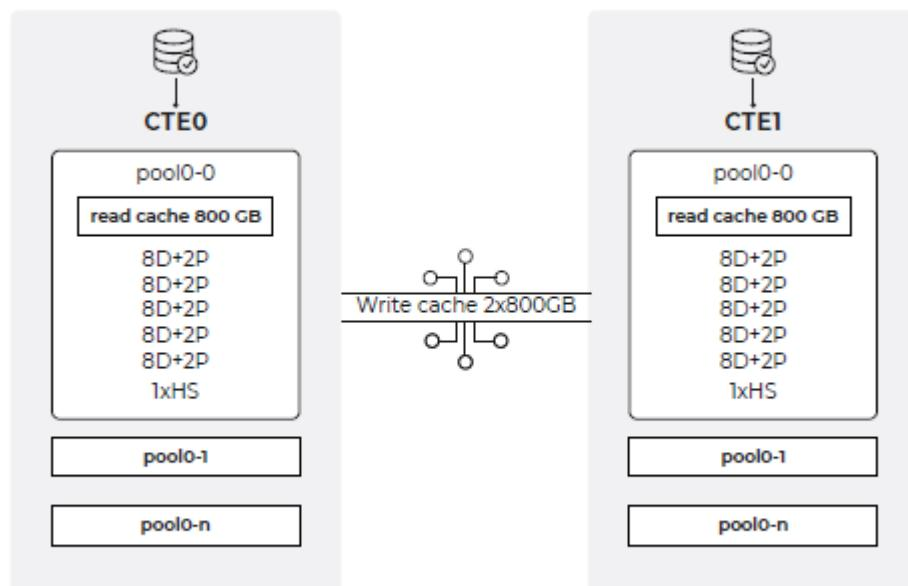
**Рисунок 2. 1 – Обычный пул на HDD дисках**
