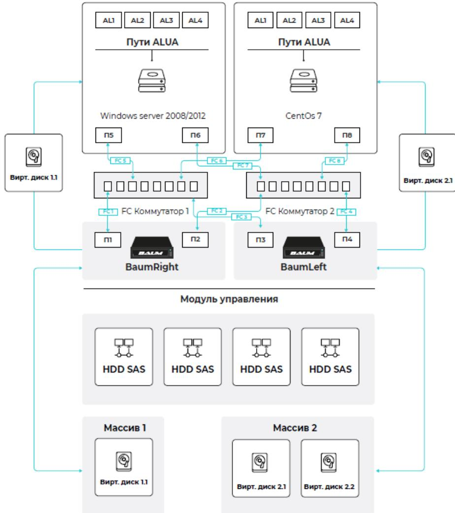
**Рисунок 225. Конфигурация BAUM STORAGE IN с ALUA**
