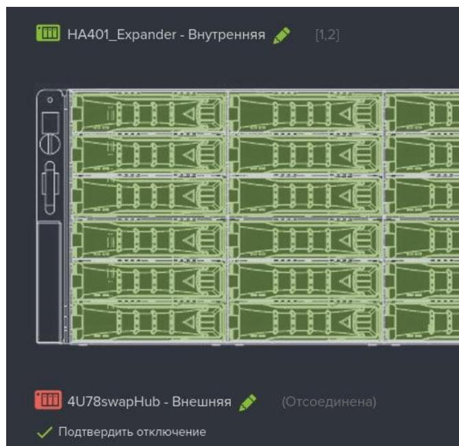
**Рисунок 51. Экран меню мониторинга после отключения питания полки**
