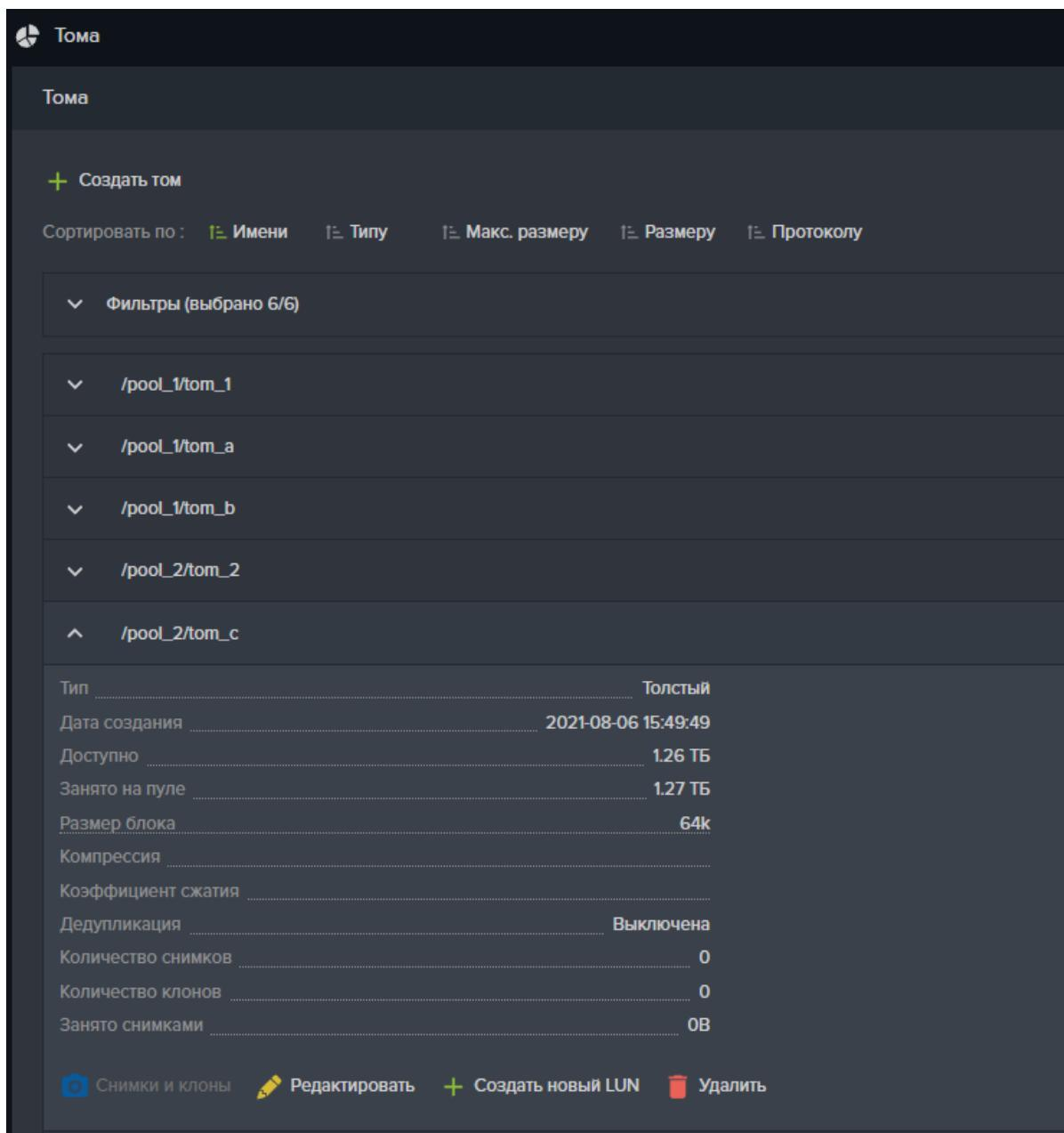
**Рисунок 75. Панель свойств тома**
