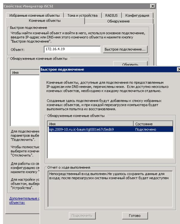
**Рисунок 183. Настройка доступа по протоколу iSCSI**
