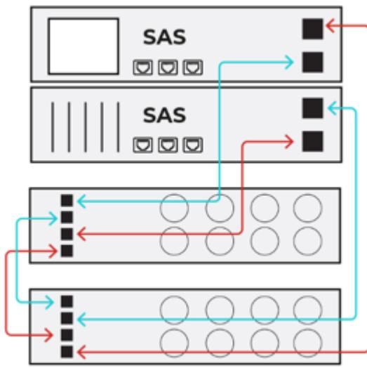
**Рисунок 228. Подключение полок по двум путям**
