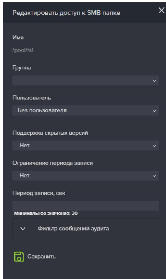
**Рисунок 112. Окно редактирования доступа к SMB-папке**
