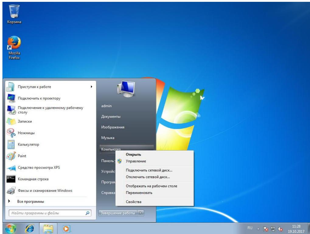
Рисунок 170. Подключение сетевого диска в Windows 7
