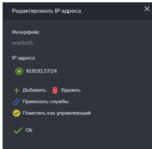
**Рисунок 45. Назначение управляющего интерфейса**
