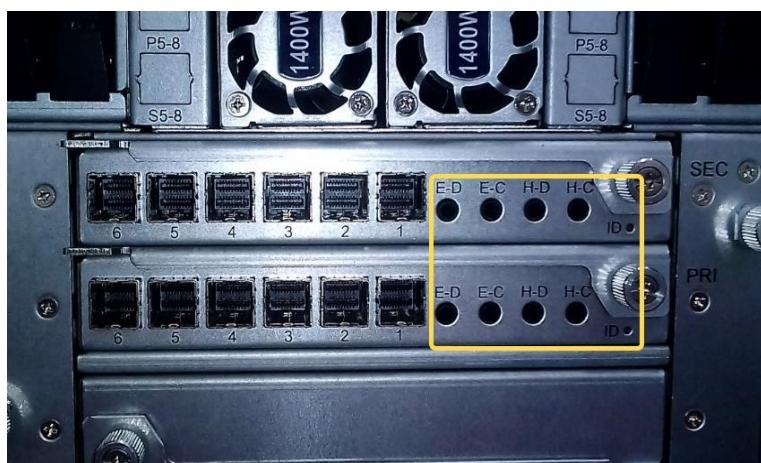
**Рисунок 3. 2. Разъёмы для подключения СОМ-кабеля на задней панели полки**
