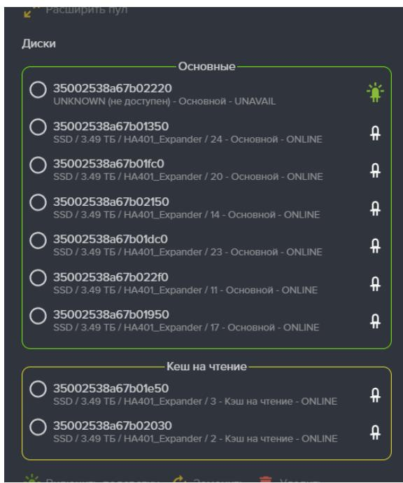
**Рисунок 69. Удаление из пула кэша на чтение**
